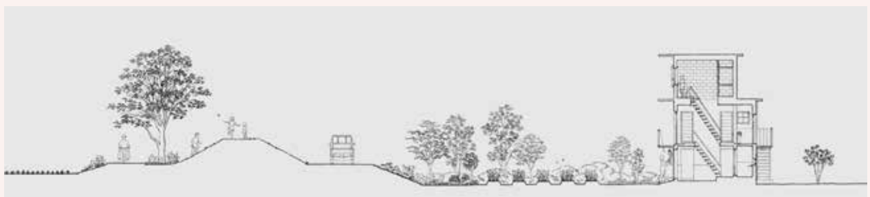
fig.4 鍋田干拓の「伊勢湾台風復興農村住宅」実測断面図: 平坂干拓では堤防法面中腹から直接出入りできる住宅北側玄関が設けられた (提供: 堀田典裕)
